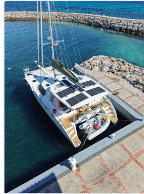
Catamarano da crociera con pannelli solari sul tetto e propulsione elettrica | © Arlin Raf / Pexels
