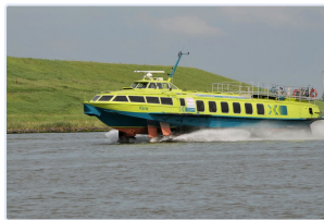
Imbarcazione a foil sollevata sui foil in navigazione (tecnologia hydrofoil) | Foto FaceMePLS, CC BY 2.0 / Wikimedia Commons
